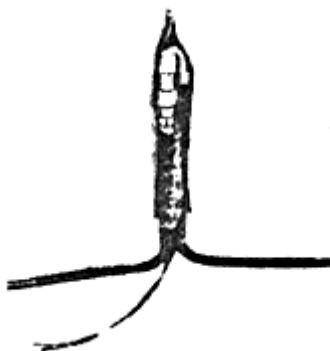
Рис.15. Изолированный участок сварного соединения
